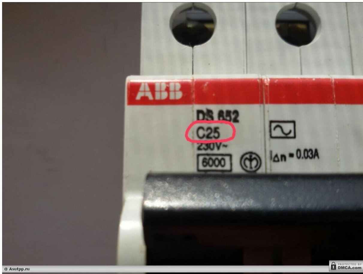
Рис. 2. C25 - время-токовая характеристика УЗО.
