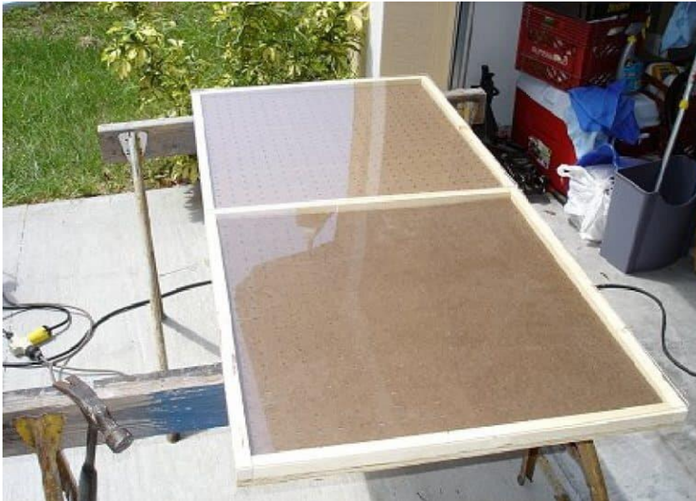
Основа из ДВП, ДСП или OSB, стекло и металлический каркас
