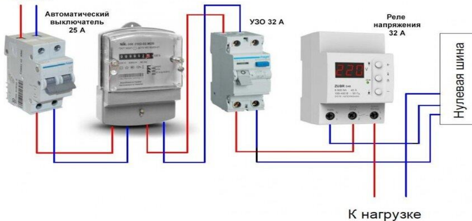
Рисунок 2: Схема подключения реле напряжения после УЗО и электросчётчика
