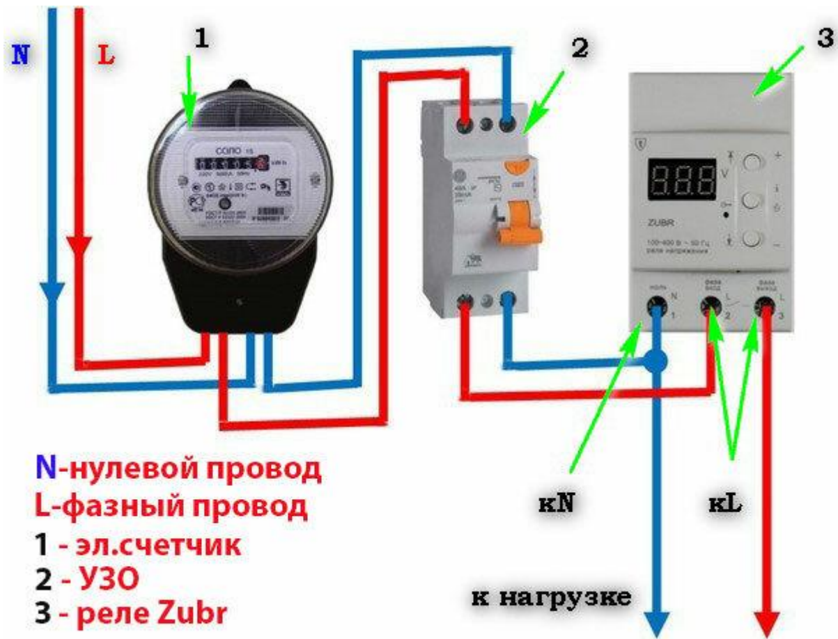
Рисунок 3: Подключение реле контроля напряжения с графической схемой
